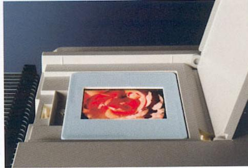
Visionneuse de diapositives incorporée: Pour faciliter le tri ou la sélection des diapositives.
