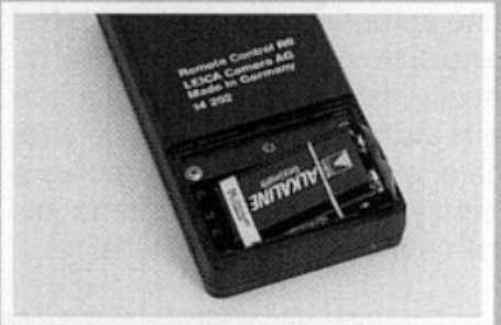
Beim Einlegen in das Fach sollte darauf geachtet werden, daß der Ausgang der Kabel aus dem Stecker im Gerät nach oben zeigt und die Kabel unter der Batterie zu liegen kommen. Danach den Deckel wieder aufsetzen und zuschrauben, wobei darauf geachtet werden muß, daß die beiden kleinen Haken am unteren Rand des Deckels in die entsprechenden Aussparungen des Gehäuses greifen.
