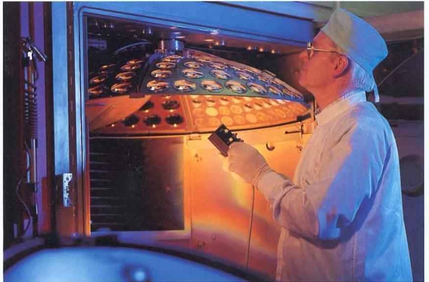
Ils en imposent par le rendu neutre et régulier des couleurs. Le traitement spécial multicouche Leica garantit une exemption presque totale de reflets. La protection contre les rayons UV est si complète qu'un filtre UV additionnel ne sert en fait qu'à protéger la lentille frontale.
