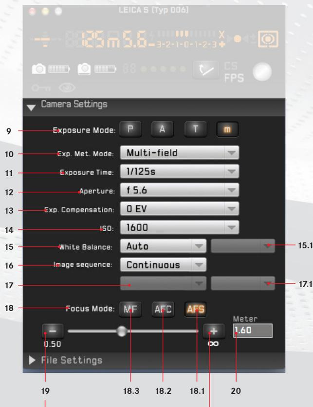
La zone **Mode d'exposition (9)** permet de sélectionner si vous souhaitez utiliser l'appareil en mode Automatisation programmé (**P**), Automatisation avec priorité au diaphragme (**A**) ou Automatisation avec priorité au temps de pose (**T**) ou définir vous-même la vitesse d'obturation et la valeur de diaphragme (**m**). **Méthode de mesure (10)**: cette zone permet de sélectionner la mesure à champs multiples, la mesure centrale pondérée et la mesure spot.
