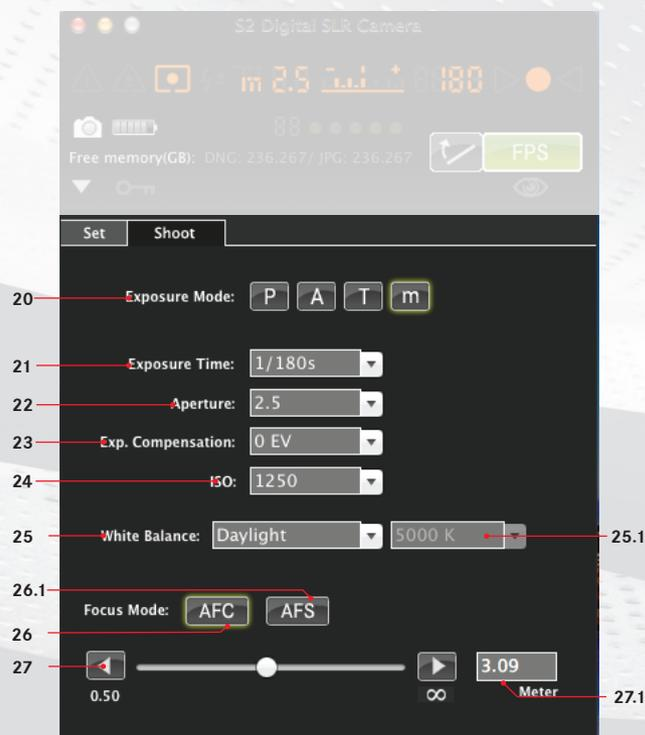
La zone **Mode d'exposition (20)** permet de sélectionner si vous souhaitez utiliser l'appareil en mode Automatisation programmé, Automatisation avec priorité au diaphragme ou Automatisation avec priorité au temps de pose (P, A, T) ou définir vous-même la vitesse d'obturation et la valeur de diaphragme (m).
