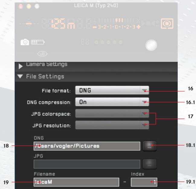
Sélectionner le format de fichier **DNG (16)** ou **JPEG** permet de définir si l'appareil photo enregistre les images au format DNG (Digital Negative, format RAW), au format JPEG ou les deux. Le champ correspondant (**18**) indique **le chemin de l'emplacement d'enregistrement** des images. Vous pouvez le modifier en cliquant sur le bouton figurant à droite du chemin (**18.1**).
