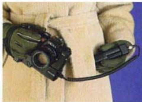
L'alimentation des MOTOR-WINDER et MOTOR-DRIVE, et par conséquent de l'appareil, peut se faire à distance, au moyen d'un adaptateur, ce qui permet de conserver les piles ou accus à la chaleur de son propre corps lorsque le temps est très froid.
