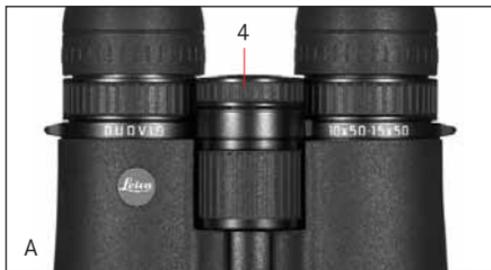
De compensatie van een individuele gezichtsafwijking voor observatie zonder bril wordt met de dioptering (4) gerealiseerd, die normaal gesproken vergrendeld is. (Figuur A). Eerst wordt met de centrale focusering de rechter kijker op een object scherp gesteld. Daarna wordt de dioptering door trekken ontkoppeld. (Figuur B).
