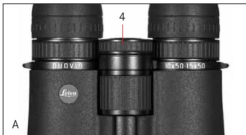
La compensation d'une amétropie individuelle dans le cas d'une observation sans lunettes de vue s'effectue à l'aide de la bague de réglage dioptrique (4) qui est verrouillée en temps normal (Image A). Procédez dans un premier temps au réglage de la netteté pour le tube *droit* avec la bague de mise au point centrale. Découplez ensuite la bague de réglage dioptrique en tirant sur celle-ci (Image B).
