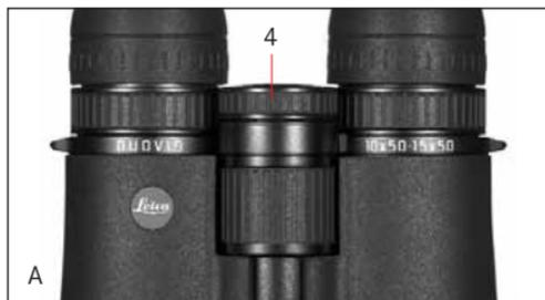
La compensación de una visión incorrecta individual para la observación sin gafas es llevada a cabo por el anillo de dioptrías (4) que, normalmente, está bloqueado (figura a). En primer lugar se enfoca nítidamente sobre un objeto con el anillo de enfoque central para el tubo *derecho*. Después se desacopla el anillo de dioptrías tirando de él (figura b).
