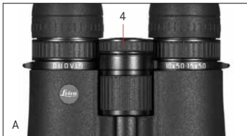
La compensazione di difetti visivi individuali per l'osservazione senza occhiali viene effettuata con l'anello diottrico (4), che normalmente è bloccato (Immagine A). Dapprima si mette a fuoco il tubo *destro* su un oggetto mediante l'anello di focalizzazione centrale. Successivamente, l'anello diottrico viene disaccoppiato tirandolo. (Immagine B).
