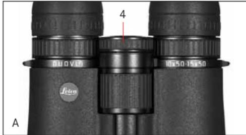
Der Ausgleich individueller Fehlsichtigkeit für die Beobachtung ohne Brille wird mit dem Dioptrienring (4) vorgenommen, der normalerweise verriegelt ist. (Bild A). Zuerst wird mit der Zentralfokussierung das rechte Rohr auf ein Objekt scharf gestellt. Dann wird der Dioptrienring durch Ziehen entkoppelt. (Bild B).
